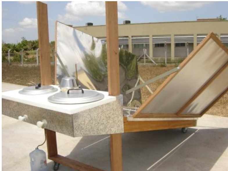
Figura 3: Fotografia do fogão solar. Fonte: Próprio autor (2012).
