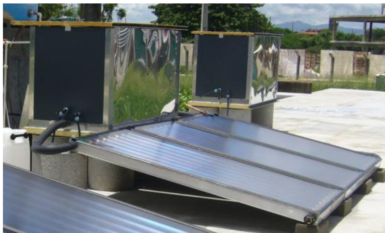
Figura 4: Fotografia do dessalinizador solar. Fonte: Próprio autor (2012).
