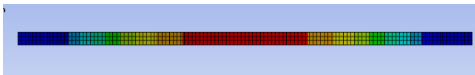
Figura 58 - Distribuição das tensões principais máxima na estrutura (AUTOR, 2021).
