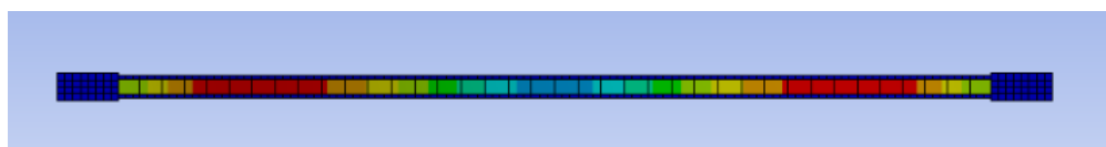
Figura 50 - Distribuição das tensões de von Mises na face inferior da viga (AUTOR, 2021).
