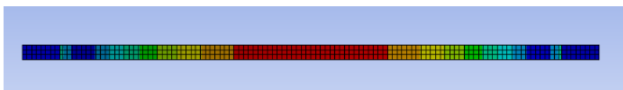
Figura 62 - Distribuição das tensões de von Mises na face inferior da viga (AUTOR, 2021).
