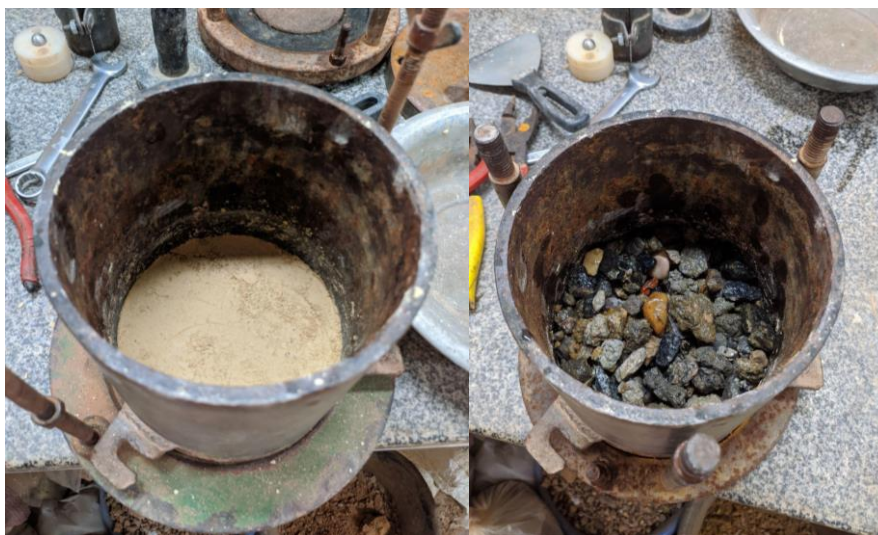
Figura 30: Aplicação de uma camada de pedra sobre uma camada de solo na câmara do permeâmetro.
