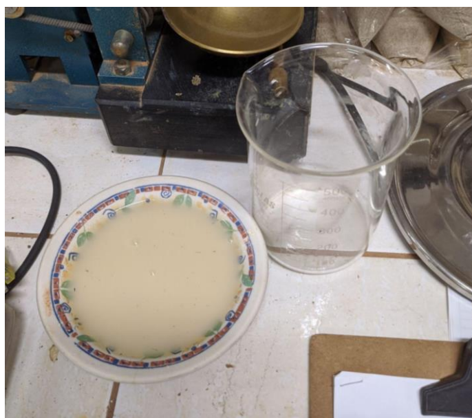
Figura 15: Amostra de solo imersa no defloculante.
