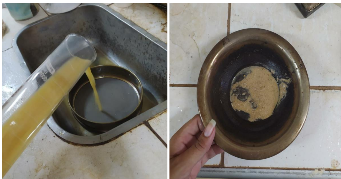
Figura 18: Transferência da mistura para a peneira de 0,075 mm para ser levada à estufa.
