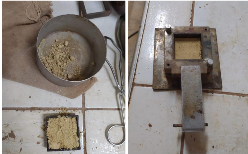
Figura 32: Preparação do corpo de prova e desmolde na célula de cisalhamento.
