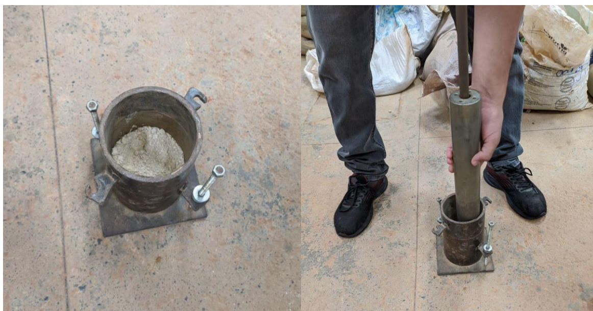
Figura 24: Compactação com soquete em três camadas de solo no cilindro metálico.
