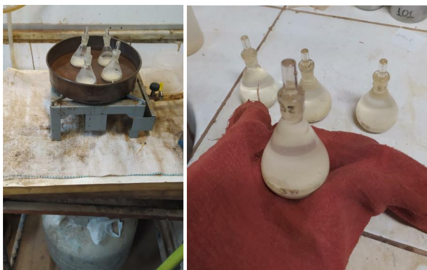
Figura 27: Aquecimento do picnômetro (à esquerda) e o mesmo sendo enxugado (à direita).
