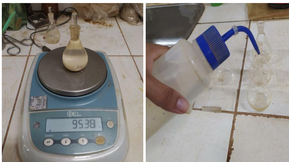
Figura 28: Pesagem do conjunto (picnômetro+amostra+água), P3 (à esquerda) e adição de água destilada aos picnômetros (à direita).
