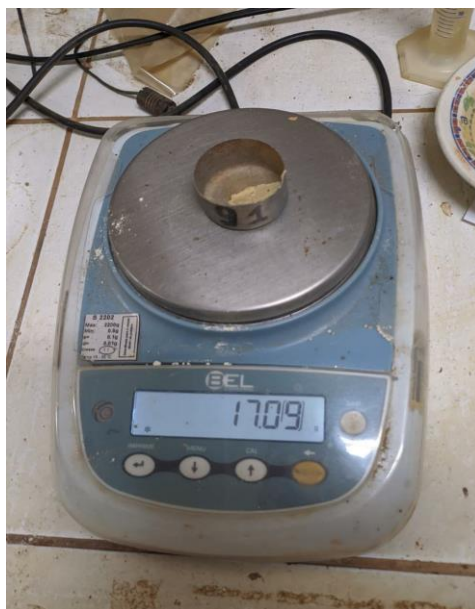
Figura 21: Pesagem de amostra para determinação da umidade - LL.
