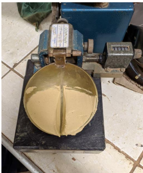
Figura 20: Aparelho de Casagrande para a determinação do limite de liquidez.
