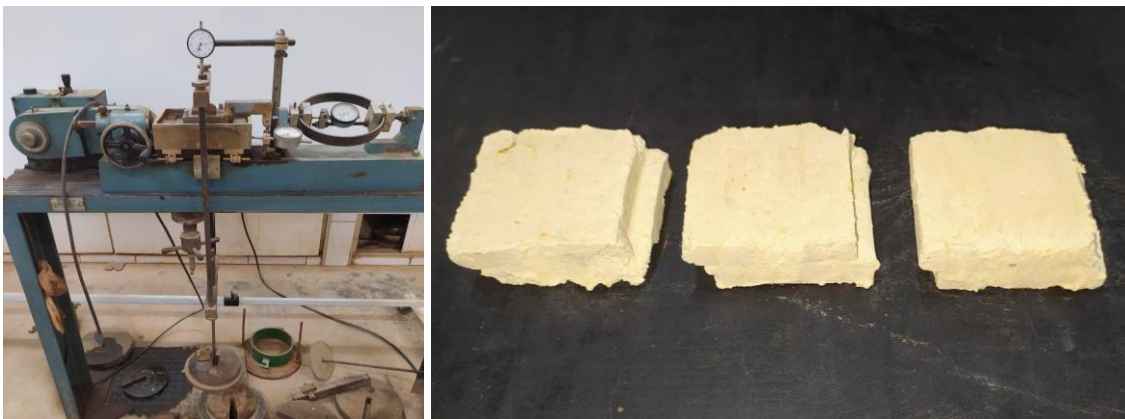
Figura 33: Equipamento para o ensaio de cisalhamento direto e corpo de prova após a ruptura.
