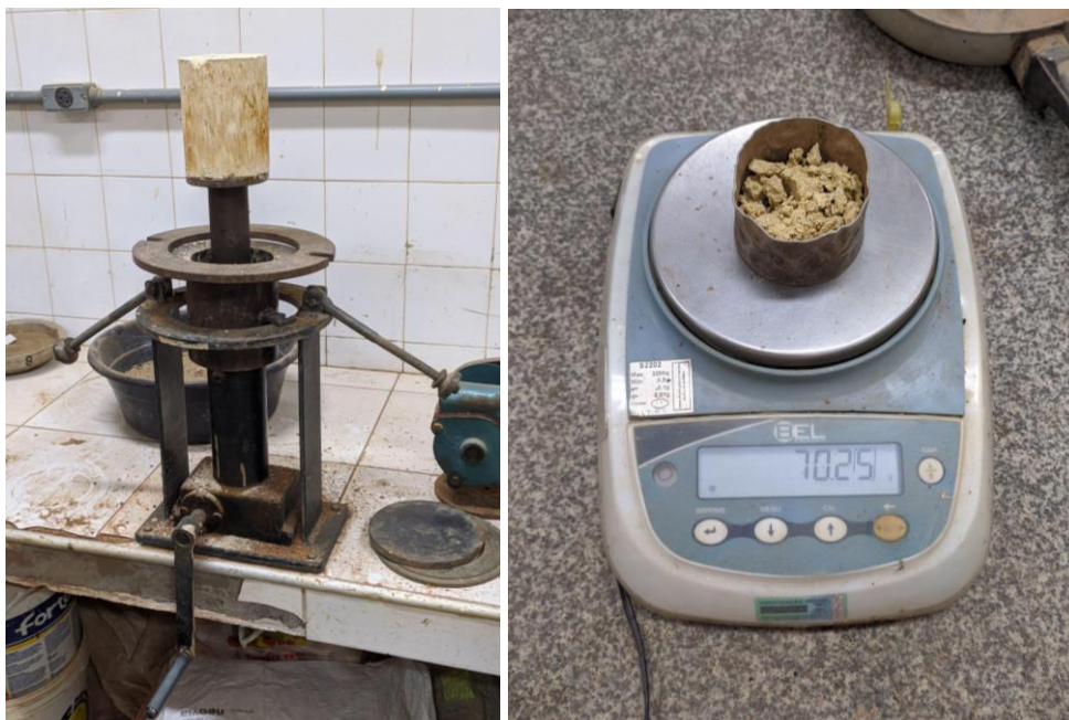
Figura 25: Extrator de corpo de prova e pesagem de uma porção.
