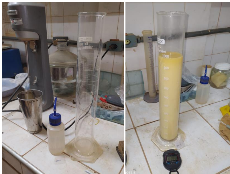
Figura 17: Transferência da mistura contida no copo dispersor para a proveta.
