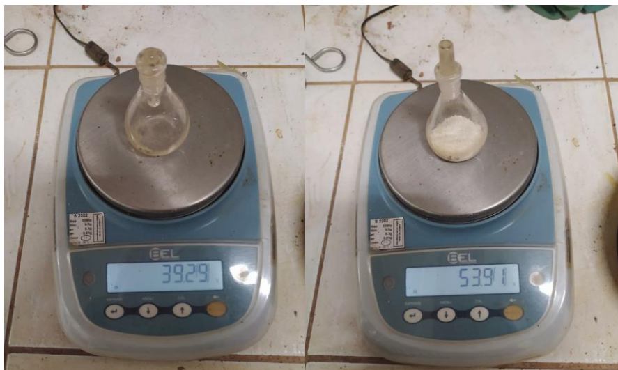
Figura 26: Pesagem do picnômetro seco, P1 (à esquerda) e do picnômetro com a amostra, P2 (à direita).
