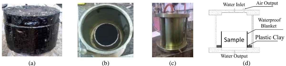
Figura 2 - Ilustração das etapas para realização do ensaio de permeabilidade: a) impermeabilização lateral, b) vista interna do permeômetro, c) permeômetro e d) ilustração do permeômetro
