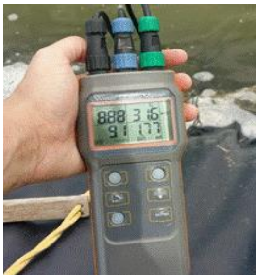
Figura 8 – Medidor multiparâmetro utilizado para análises de água.
