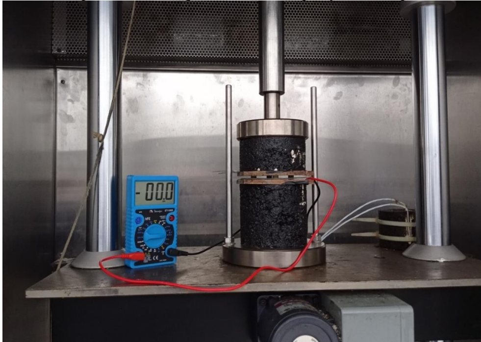
Figura 21 – Protótipo laboratorial de geração de energia
