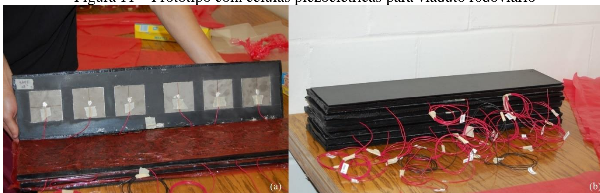
Figura 11 – Protótipo com células piezoelétricas para viaduto rodoviário
