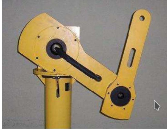
Figura 11 – Robô de dois graus de liberdade cujo modelo dinâmico é usado nas simulações computacionais relacionadas nesta seção.
