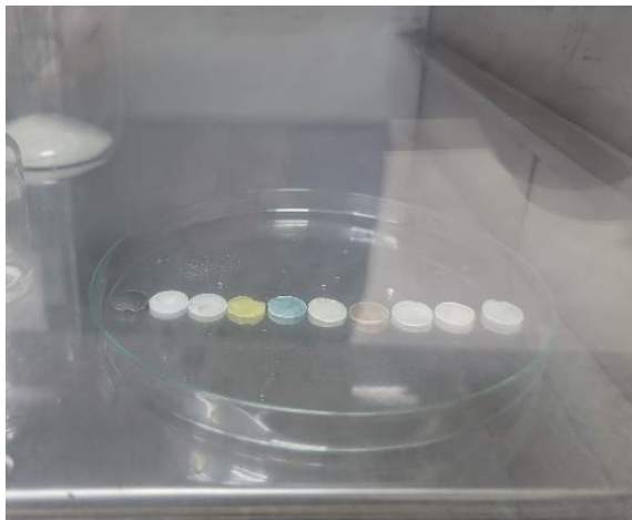
Figura 13 - Pastilhas de brometo de potássio (KBr) contendo a amostra de MP
