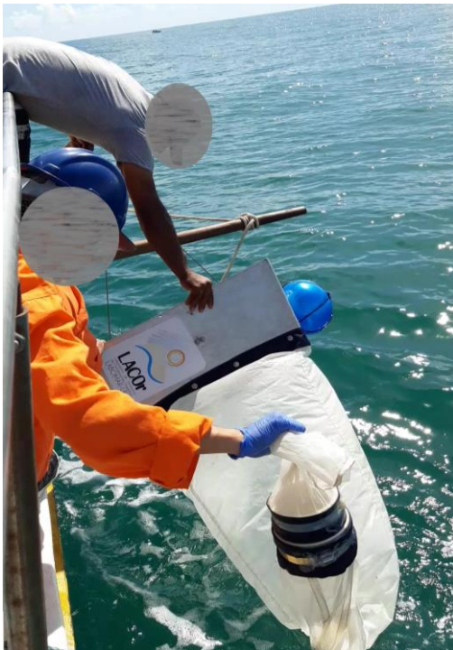
Figura 7 - Rede tipo Neuston utilizada para a coleta de amostras de água
