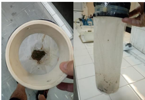
Figura 8 - Coletor com tamanho de malha de 100 \mu\text{m}
