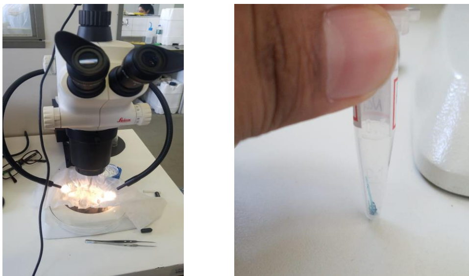
Figura 10 - Microscópio estereoscópico utilizado para separar MPs à esquerda e tubo eppendorf com partículas de MPs à direita
