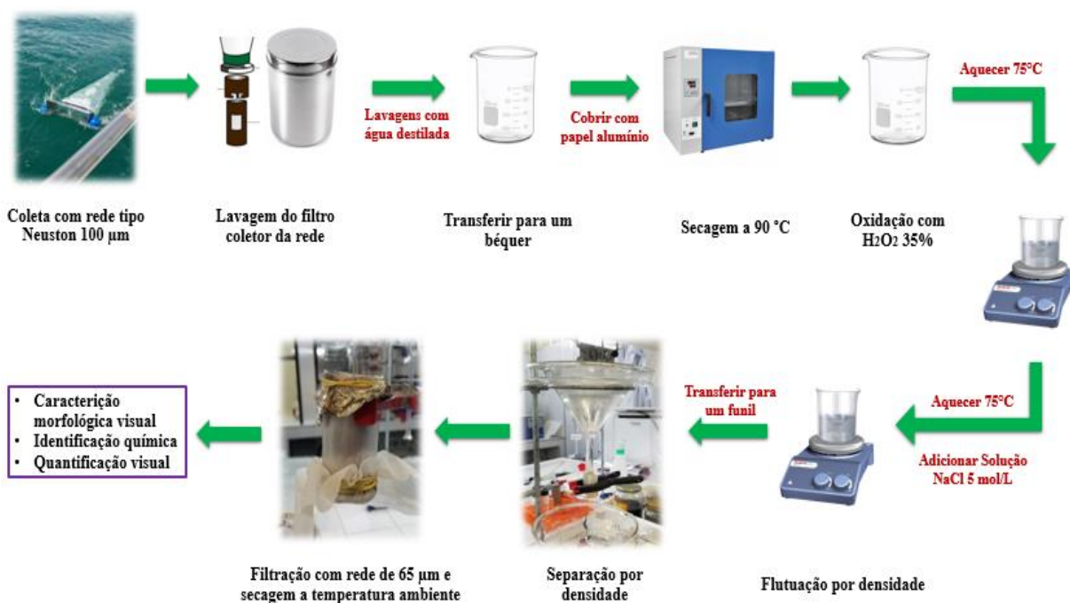
Figura 9 - Visão geral da metodologia utilizada no pré-tratamento e extração de MPs das amostras de água para posterior análise
