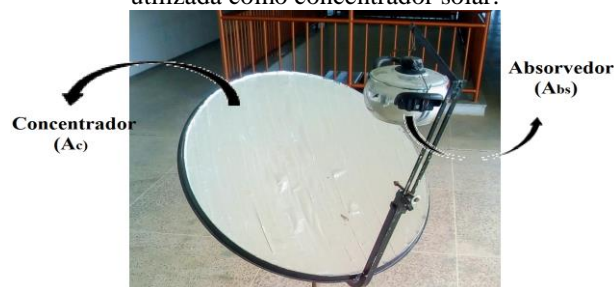
Figura 2 – Antena parabólica utilizada como concentrador solar.
