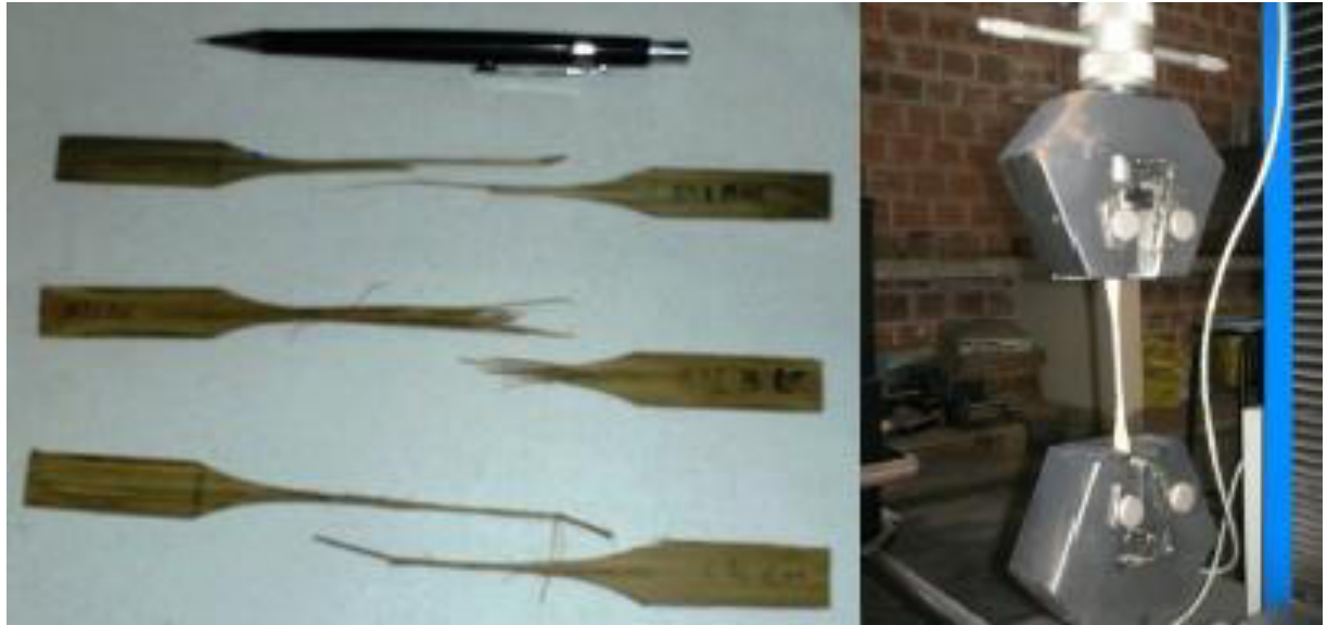
Figura 34 – Corpo de prova de bambu utilizado nos ensaios de tração axial paralela às fibras e Prensa utilizada para a realização do ensaio.
