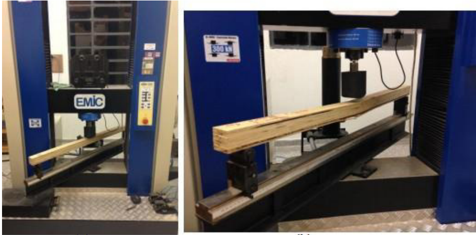
Figura 36 – Ensaio de flexão na máquina universal de ensaios mecânicos.
