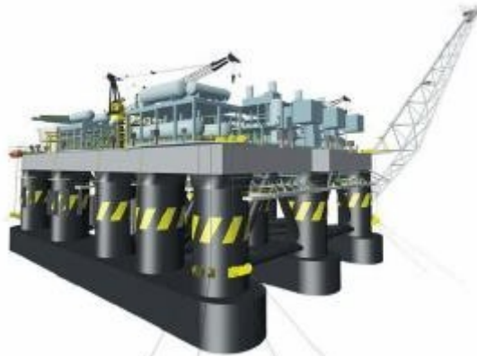
Figura 3 - Ilustração de plataforma semissubmersível
