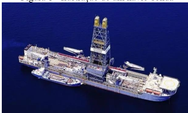
Figura 6 - Ilustração de um navio-sonda
