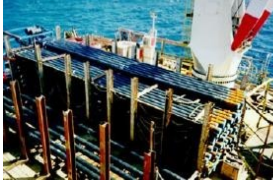
Figura 11 – Riser rígido a bordo de uma embarcação
