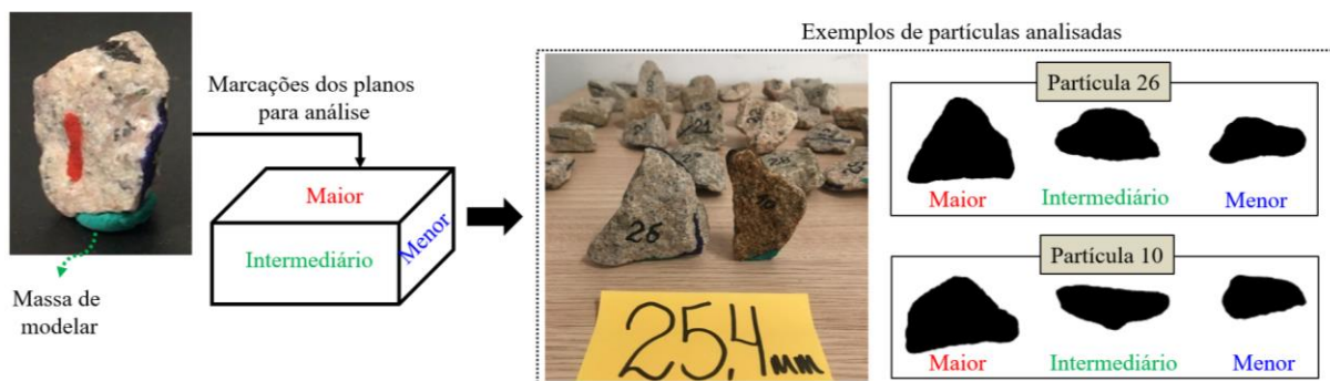
Figura 4.22 – Análise e obtenção das imagens 2D na fração 25,4 mm: exemplo das partículas de número 10 e 26
