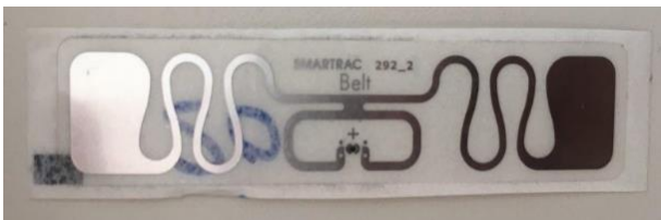
(a) Etiqueta inteligente Belt da Smartrac
