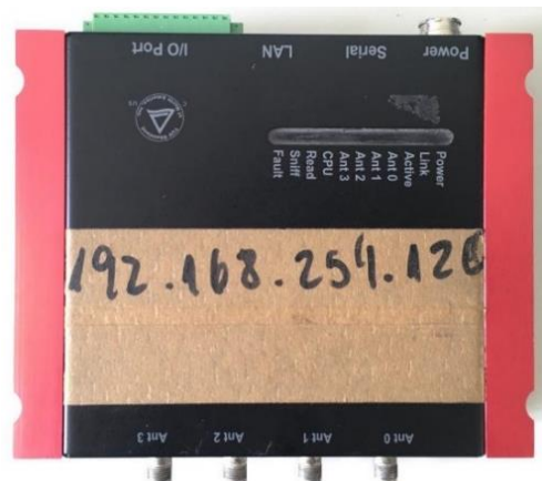
Fig. 3. Leitor de RFID fixo ALR-9900.
