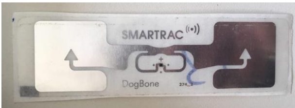
(b) Etiqueta inteligente DogBone da Smartrac
