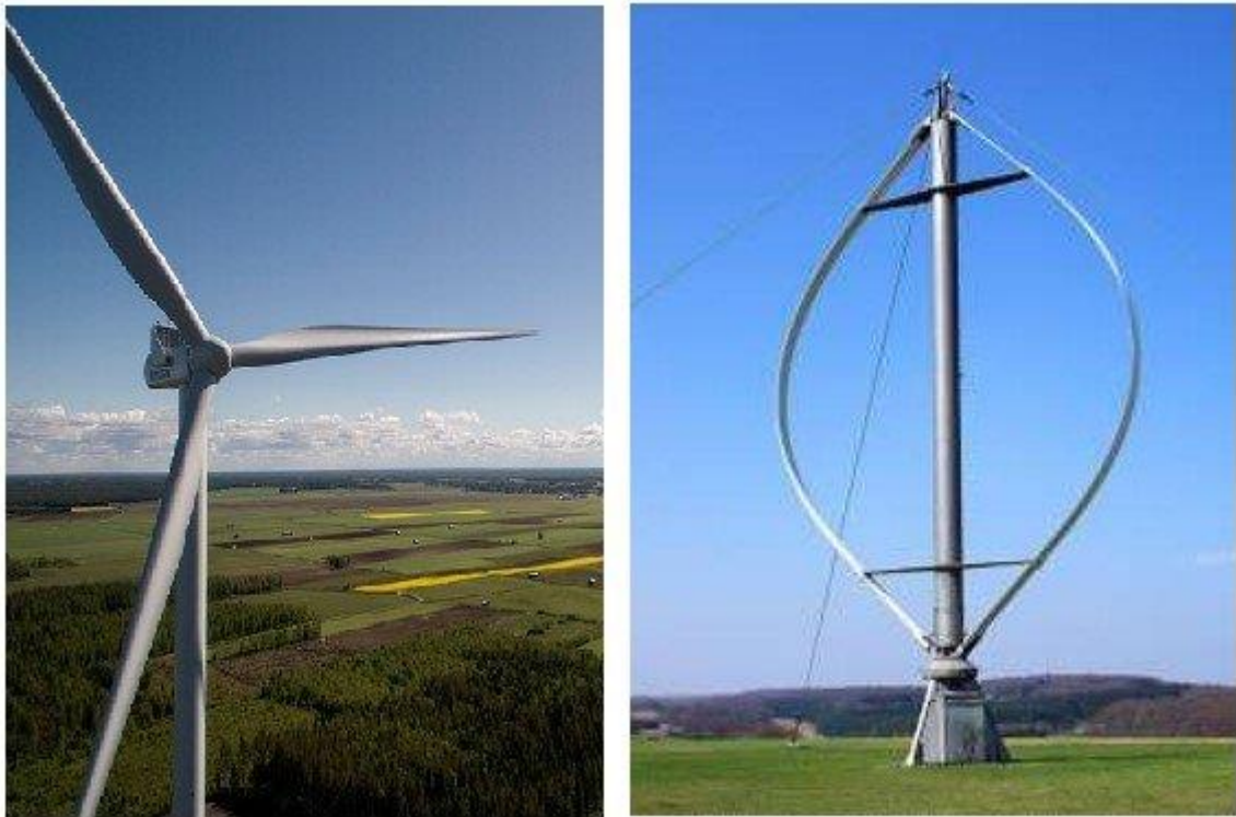
Figura 1 – Tipo de aerogeradores: à esquerda TEEH, à direita TEEV.
