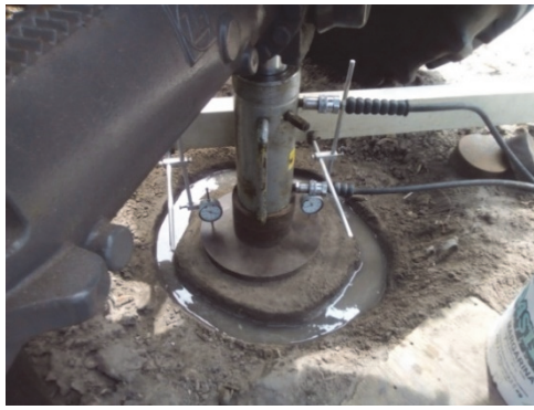
Fig. 6 – Canal de inundação em torno da placa.
