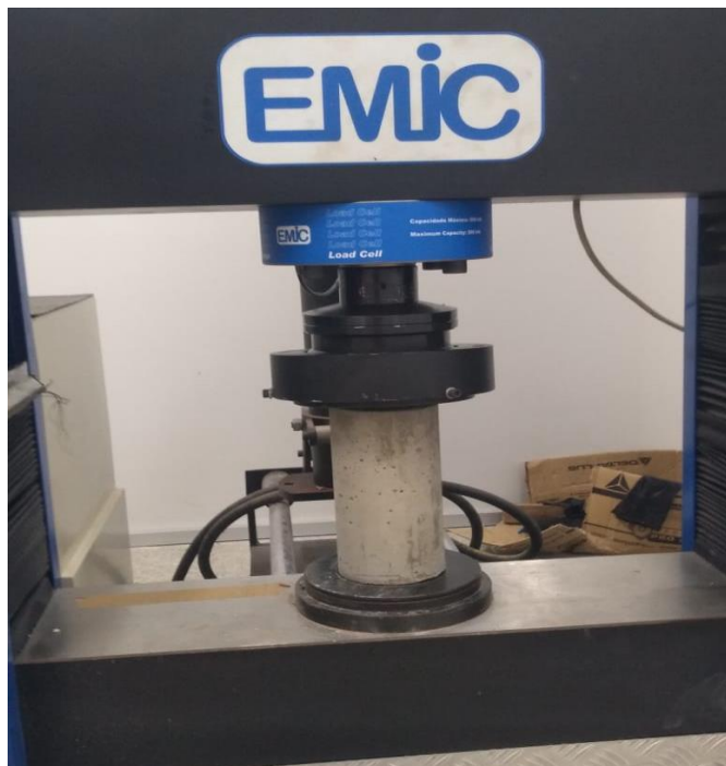
Figura 25: Rompimento do corpo de prova.
