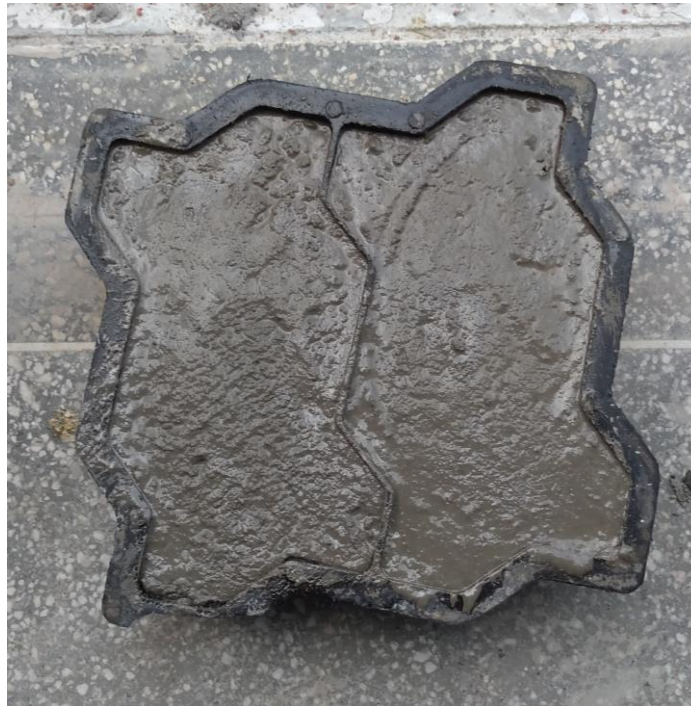
Figura 24: Moldagem do corpo de prova 16 faces.
