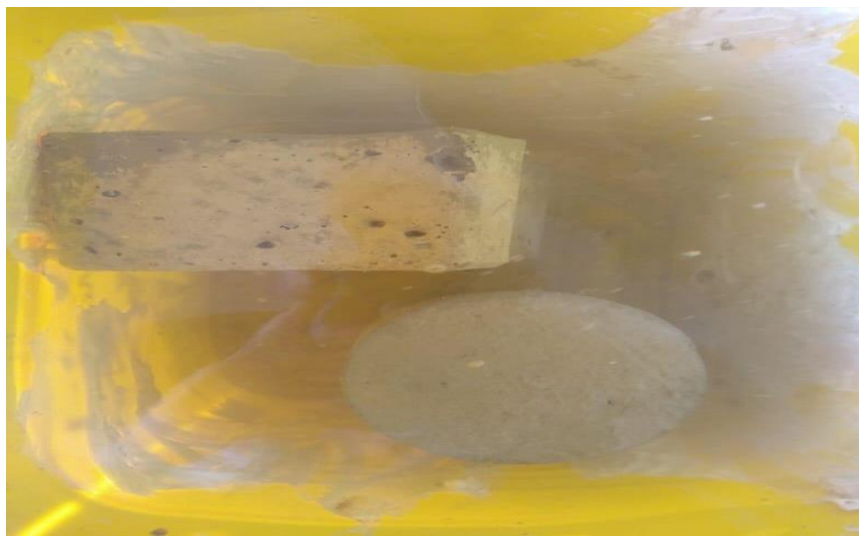
Figura 17: Corpos de provas em submersão.
