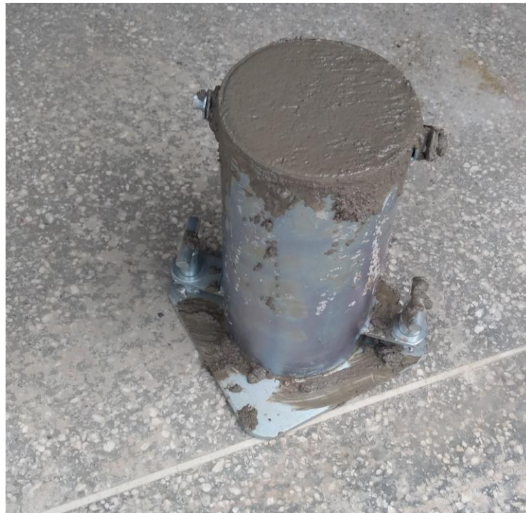
Figura 23: Moldagem do corpo de prova cilíndrico.
