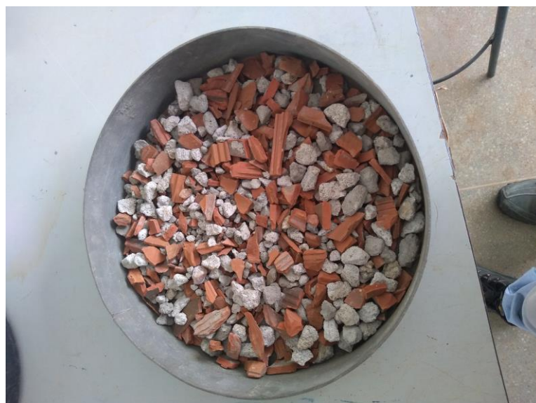
Figura 13: RCD depois de serem separados pelas peneiras.
