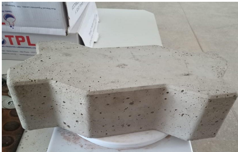
Figura 11: Pavers para pavimentação.
