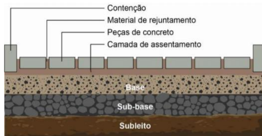
Figura 6: estrutura dos pavimentos - Pavimentos intertravados.
