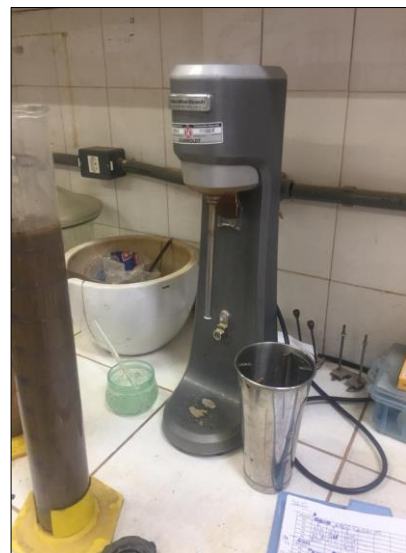
Figura 13 - Batedeira elétrica para dispersão das moléculas de argilas.
