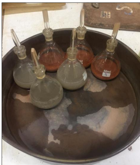
Figura 16 - Processo de "banho maria" para o ensaio de densidade real.
