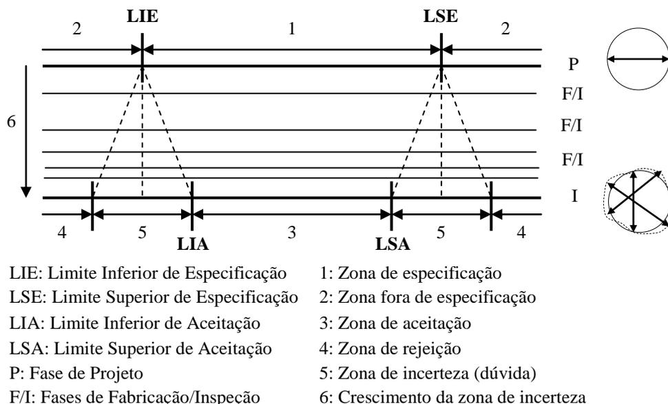
**Figura 2 – A lógica da avaliação da conformidade, adaptada de (ISO 14253-1, 1998).**
