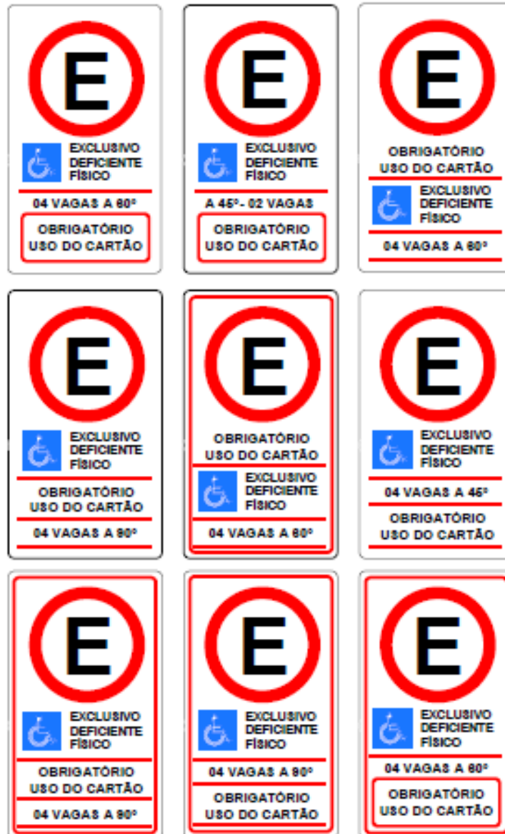
Figura 73 - Modelo de sinalização vertical para regulamentação de vagas de estacionamento de veículos destinadas exclusivamente a veículos que transportam pessoas portadoras de deficiência e/ou com dificuldade de locomoção
