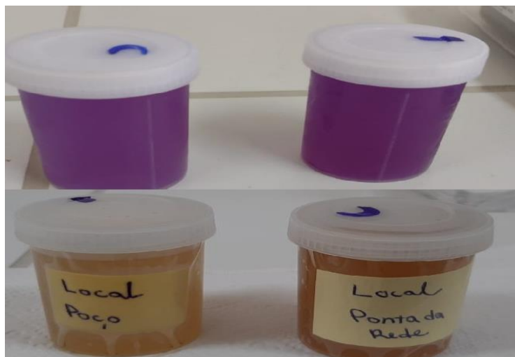
Figura 6 – Alteração colorimétrica da amostra indicando a presença de coliformes totais.
