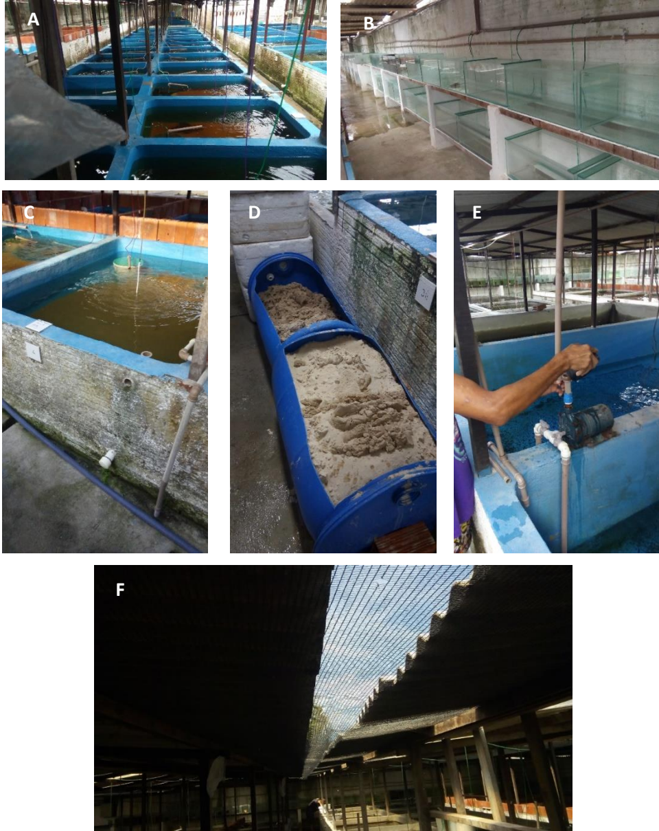
Figura 5 - Bateria de tanques (A) e aquários (B) para crescimentos de peixes; tanque com substrato de areia, sistema de filtragem e aeração, válvula inferior e superior de escoamento de água e tubulação de abastecimento (C); Recipientes utilizados para estocagem de substrato de fundo de tanque (D); Tanques para abastecimento e bomba emersa (E) e; Tela sombreadora (F).
