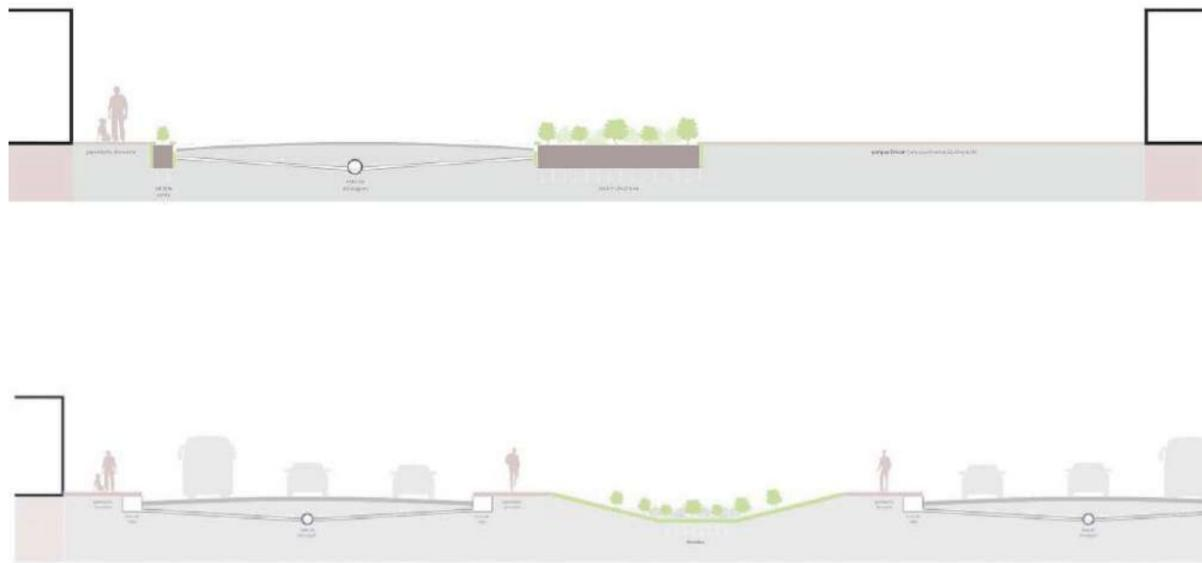
**Figura 56.** Sistema de drenagem com elementos de infraestrutura verde propostas para a ZEIS Pici: jardim de chuva na Rua Pernambuco e biovaleta na Av. Coronel Matos Dourado, respectivamente. fonte: PIRF Pici, 2019.
