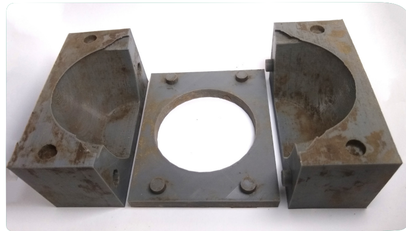
Figura 88. Peças do molde da escoredeira. Fonte: o autor.
