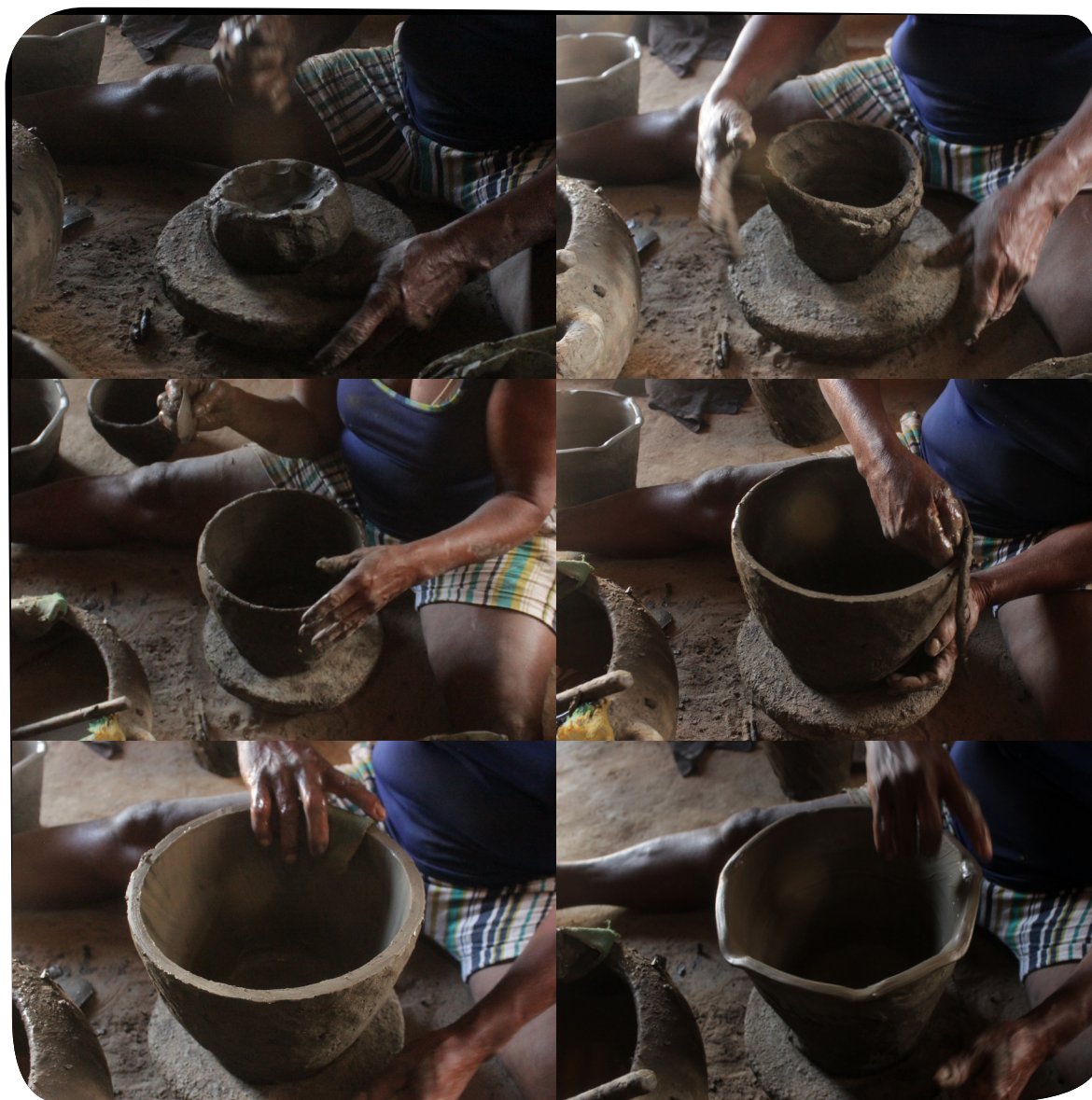
Figura 32. Etapas de moldagem de Dona Mundinha. Fonte: o autor.
