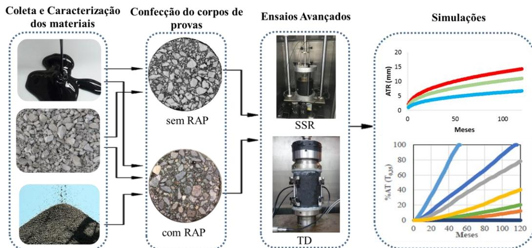
**Figura 1:** Fluxograma esquemático da metodologia proposta.
