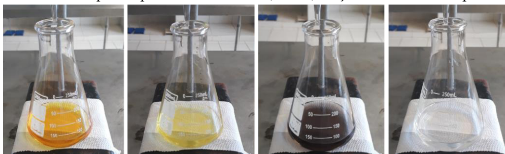
Figura 12 – Da esquerda para a direita: início, meio, adição do indicador e ponto final.
