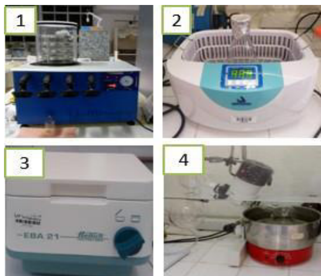
Figura 7 – Equipamentos utilizados no processo de extração a) Liofilizador b) Ultrassom 3) Centrífuga 4) Rota- evaporador.
