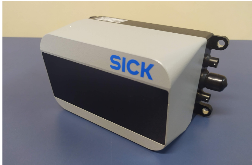
Figura 6 – Sensor LiDAR LD-MRS 420201.
