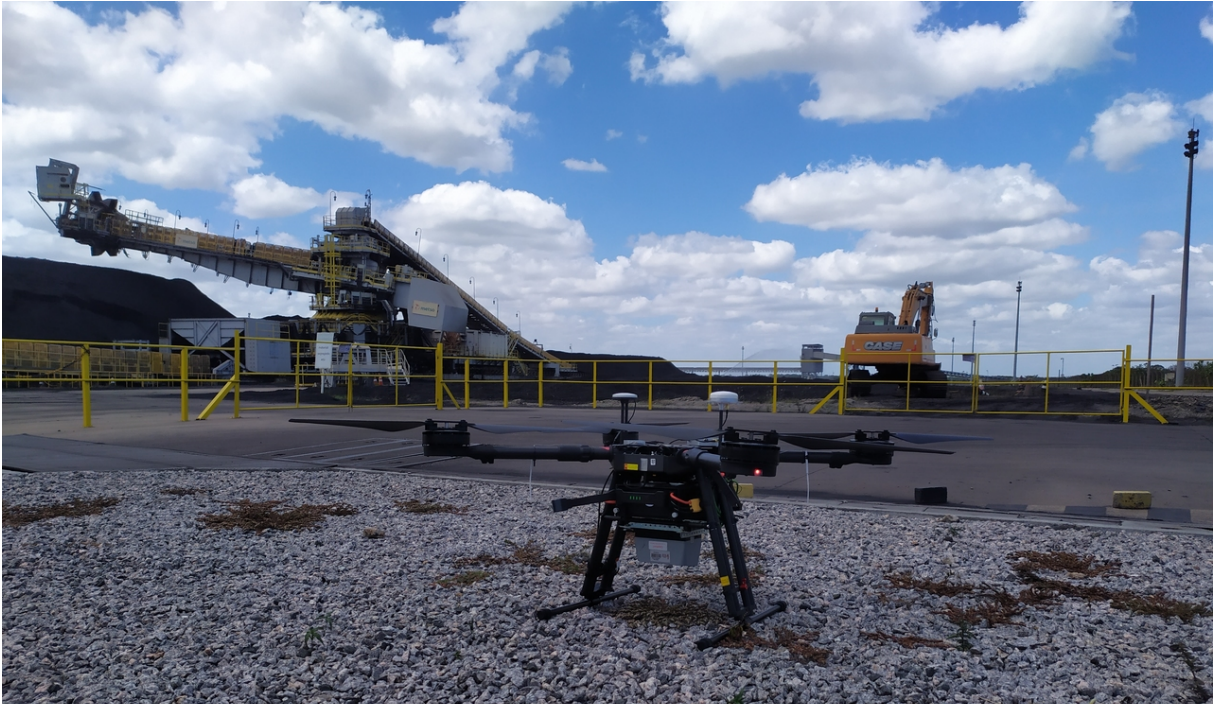
Figura 37 – Sistema aéreo de mapeamento tridimensional na termoeletrica.
