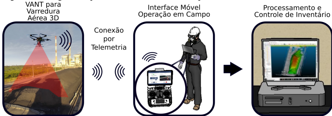
Figura 1 – Diagrama Operacional do Sistema de Mapeamento.
