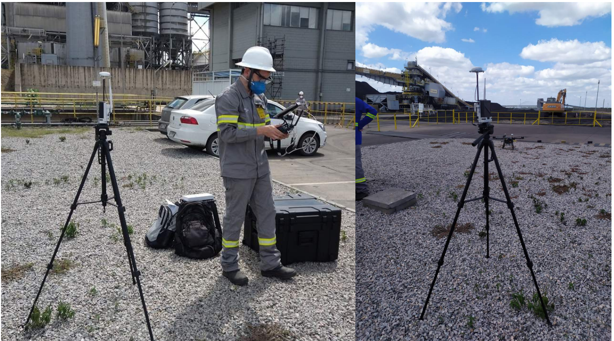
Figura 38 – Ground System do sistema de posicionamento RTK e operador com controle Lightbridge 2 e Tablet com interface gráfica.
