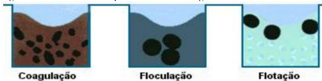
Figura 13 – Processo de flotação no tratamento de água
