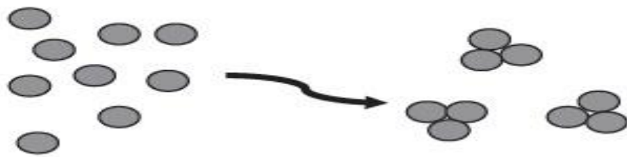
Figura 7 – Esquema do processo de floculação: agregação das partículas
