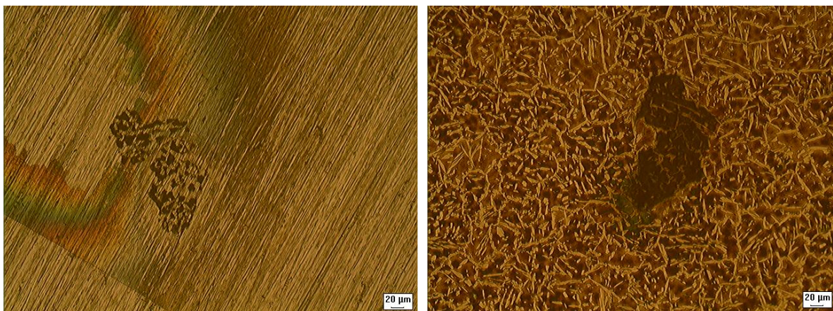
Figura 8. Micrografia do pite após o ensaio de CPT, condição I1V2. a) Lixado a 600 mesh, b) Polido. Ataque com behara modificado. Aumento de 200x.
