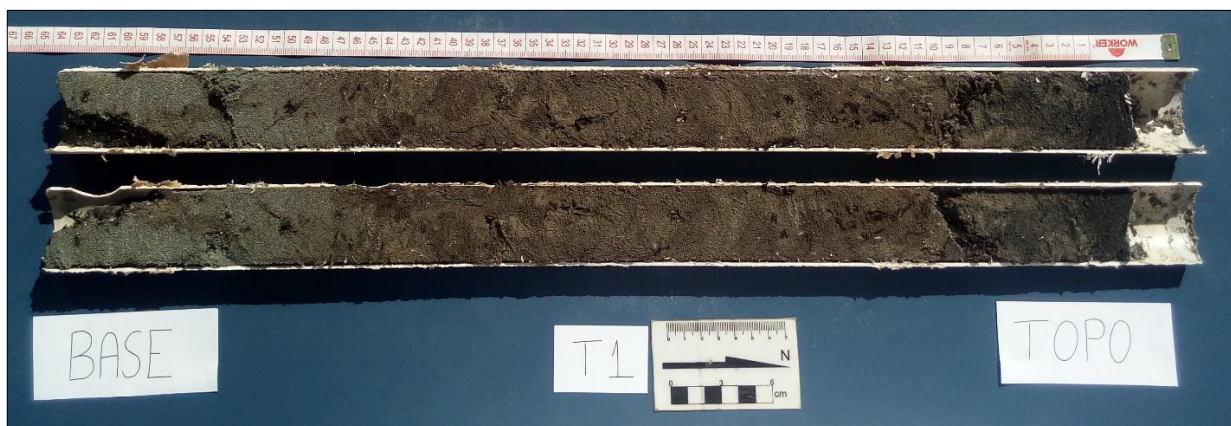
Figura 11 - Processo de identificação das fácies sedimentares do testemunho T1.
