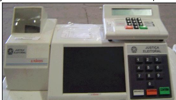
Figura 8 - Modelo UE-2002 como módulo impressor externo
