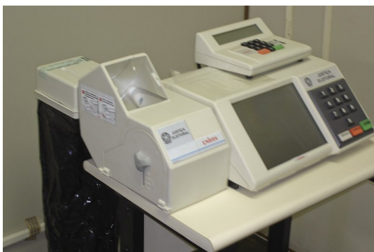
Figura 15 – Urna com módulo impressor usada em 2002
