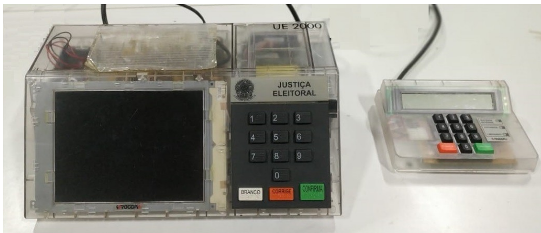
Figura 14 - Protótipo transparente da urna eletrônica modelo UE 2000
