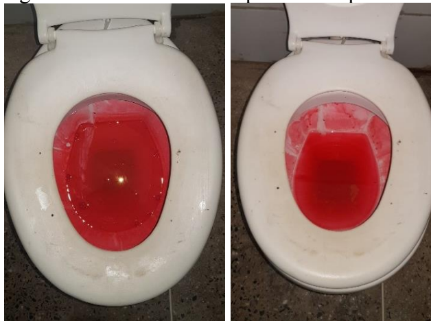
Figura 31 - Bacia antes e depois do tempo de teste
