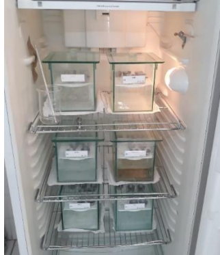
Figura 6 – Células de solução salina das isotermas de adsorção contendo amostras de pós de pitaia vermelha, colocadas em B.O.D.
