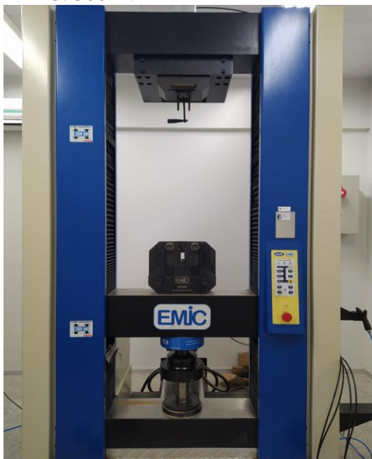
Figura 9 – Máquina de ensaio universal EMIC: 300kN
