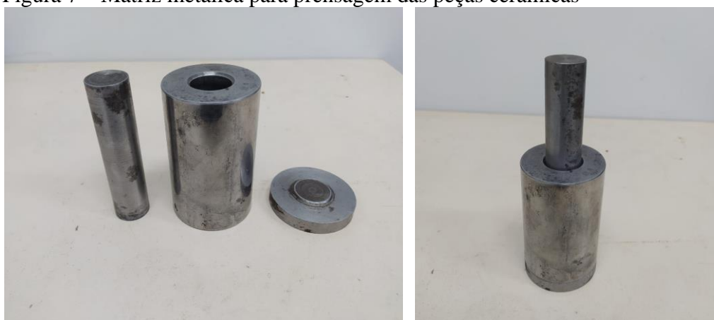
Figura 7 – Matriz metálica para prensagem das peças cerâmicas
