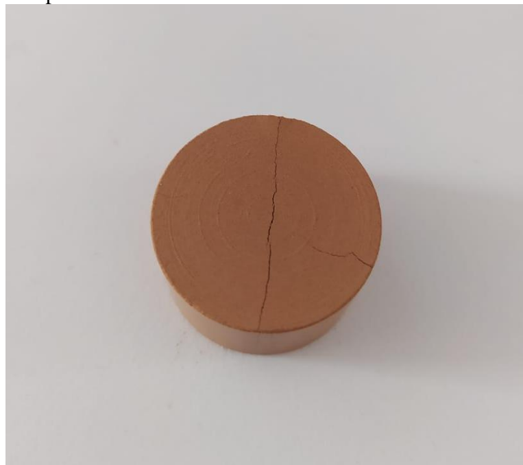
Figura 21 – Amostra fraturada da mistura 3 após a compressão diametral
