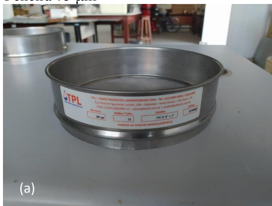
Figura 5 - Peneiras usadas na determinação da granulometria. (a) Peneira 600 \mu\text{m} . (b) Peneira 75 \mu\text{m}
