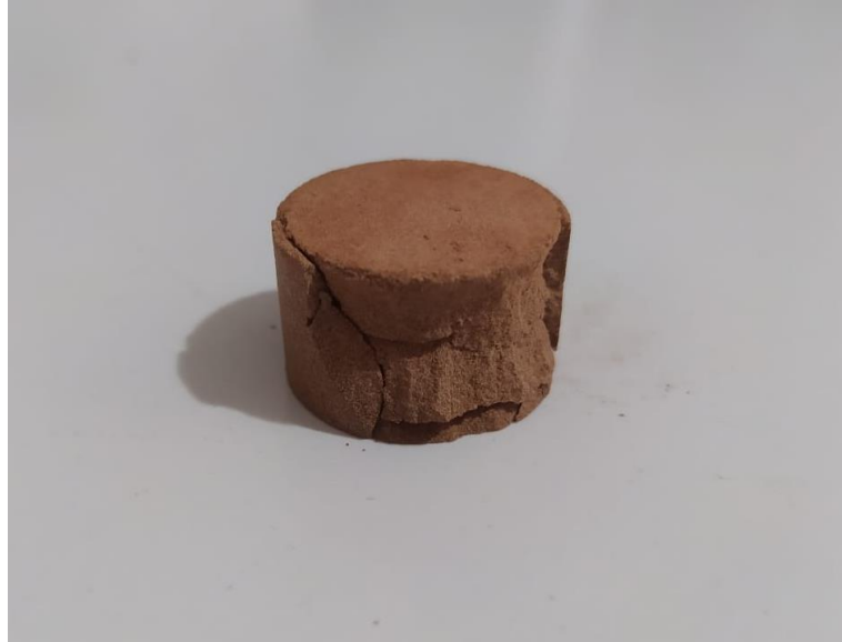
Figura 20 – Amostra fraturada da mistura 4 após a compressão axial
