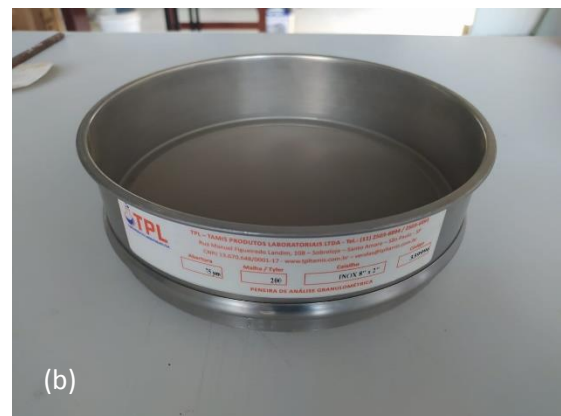
Figura 5 - Peneiras usadas na determinação da granulometria. (a) Peneira 600 \mu\text{m} . (b) Peneira 75 \mu\text{m}
