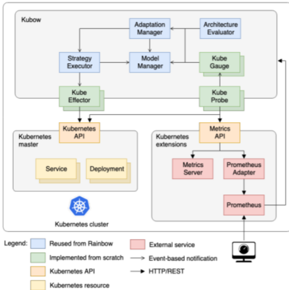
Figura 5 – Arquitetura do sistema de monitoramento Kubow.
