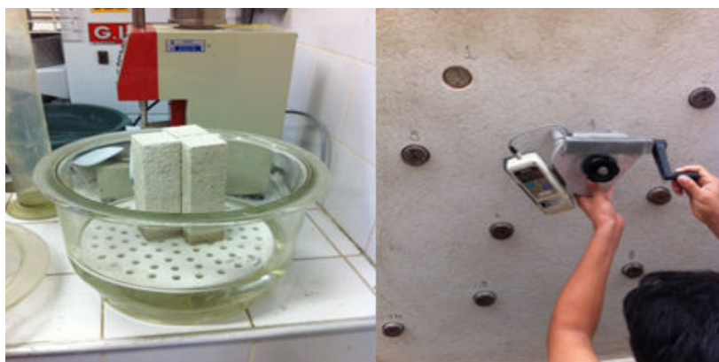
Figura 2 – a) Corpos de prova imersos em 5 mm de água. b) Ensaio de resistência de aderência à tração.
