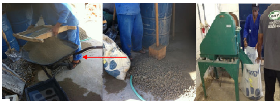
Figura 1 – a) Argamassa sendo moída. b) Apiloamento da argamassa moída. c) Peneiramento da areia reciclada em abertura 4,8mm.
