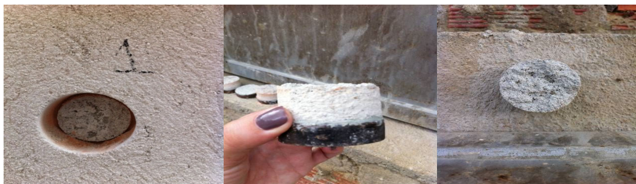
Figura 3 - Substrato e amostra após o rompimento.
