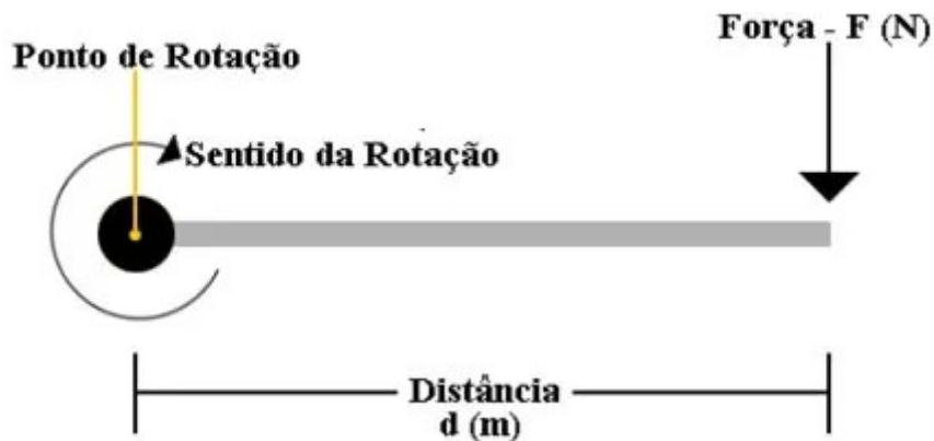
Figura 5.1 Exemplo de forças atuante em um ponto de rotação
