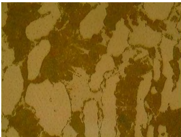
Figura 7. Amostra envelhecida a 850°C durante 1h30min. Microscopia ótica, ataque eletrolítico com solução de 10% de KOH. Aumento de 1000X.
