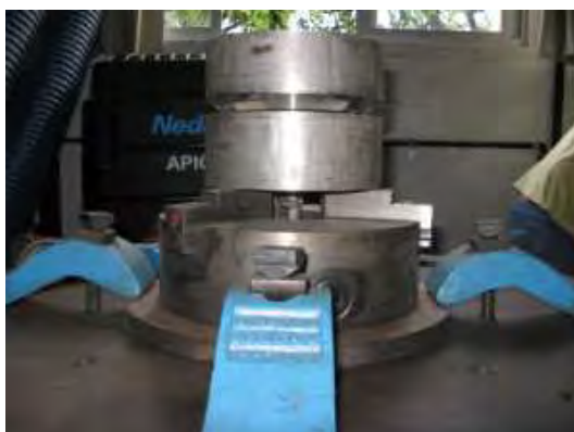
Figura 5. Detalhe da montagem dos tubos na bancada de soldagem.
