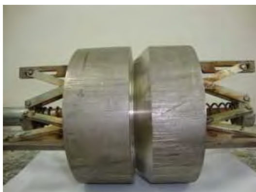
Figura 4. Junta montada no mecanismo de alinhamento e pronta para se pontear.
