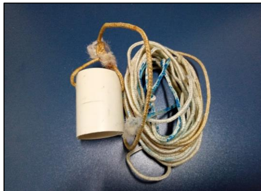
Figura 34 – Cano usado para prender as “cabeças” das abraçadeiras de nylon sobre o anel de sustentação da garrafa
