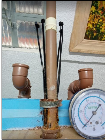
Figura 33 - Representação do gatilho feito com as abraçadeiras de Nylon e a ou as abraçadeiras de metal
