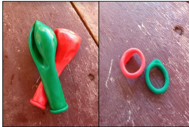
Figura 32 – anel para eliminar folga entre tubo de lançamento e tubeira do foguete
