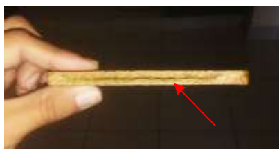
Figura 4 – Corpo de prova com 20% de resina apresentando rachadura
