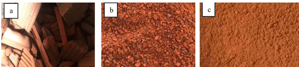
Figura 1 – Beneficiamento do RCV. (a) Material colhido na empresa; (b) Material após triturador de mandíbula; (c) Material após moagem e peneiramento.
