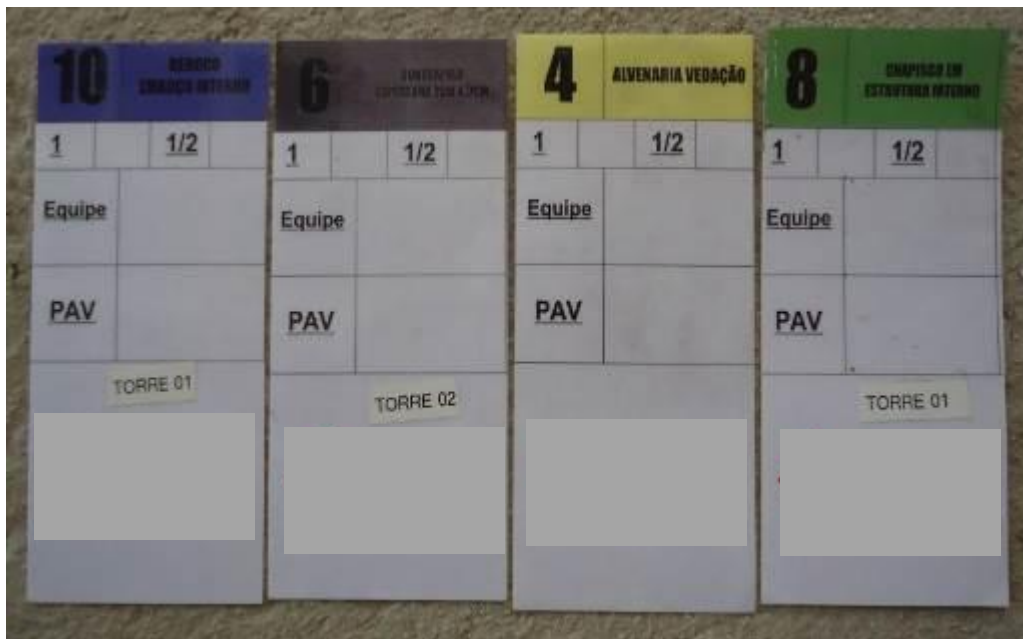
Figura 53 - Tipos de Kanban - Separação por cores
