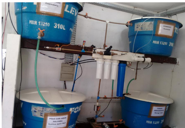
Figura 6 – Planta de dessalinização experimental.
