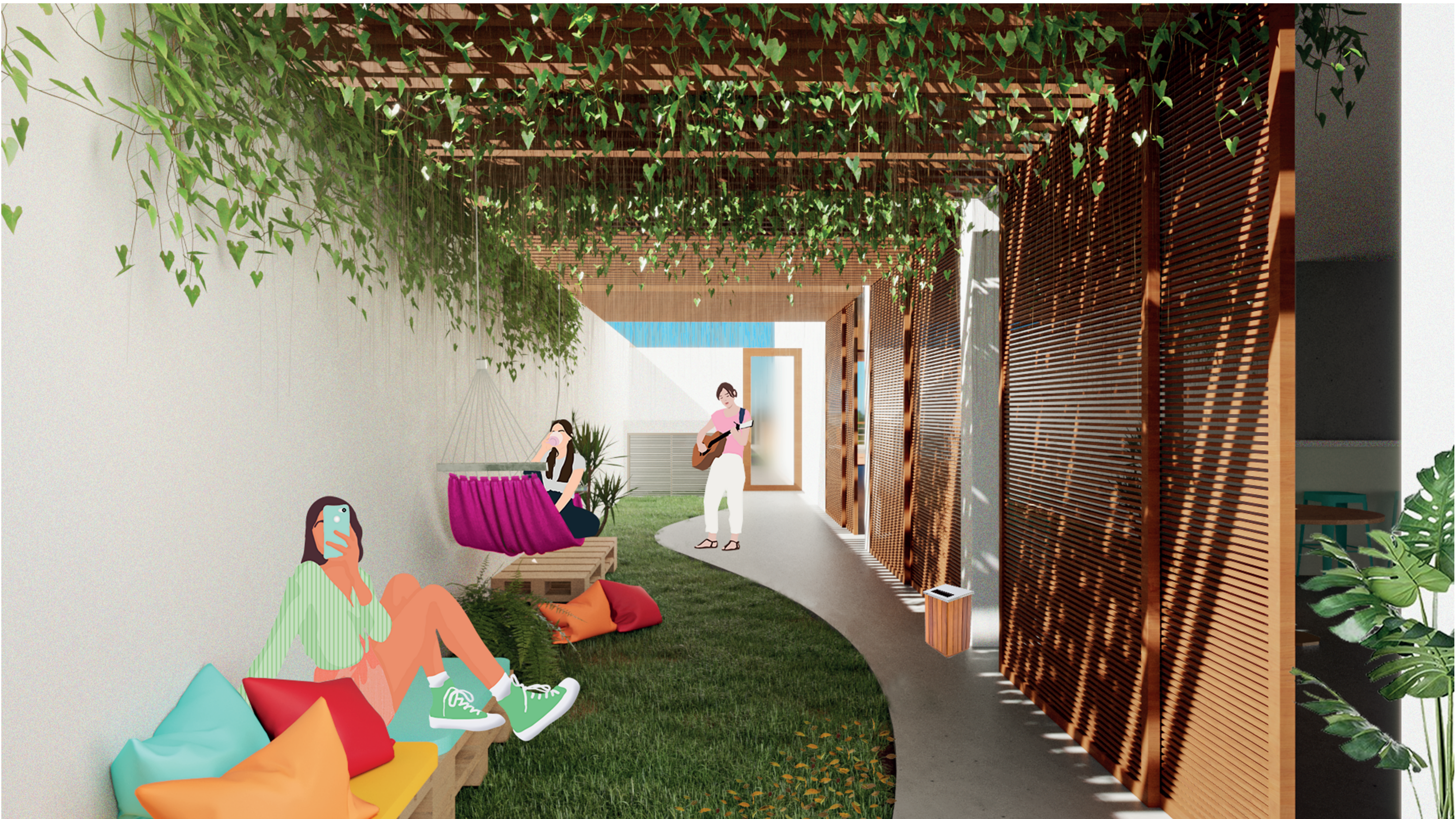
Figura 67 - Perspectiva interna do Pátio Externo Voltado para oeste, o jardim busca ser integrado ao refeitório. Ele é coberto pelo pergolado e trepadeiras como forma de reduzir a incidência solar e melhorar a sensação de conforto. Fonte: Maquete de Autoria Própria / Pós-produção por Rodinely Sousa
