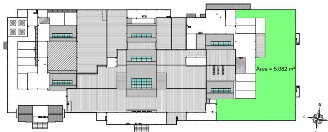
Figura 2 – Planta baixa da cobertura do shopping com indicação da área disponível.
