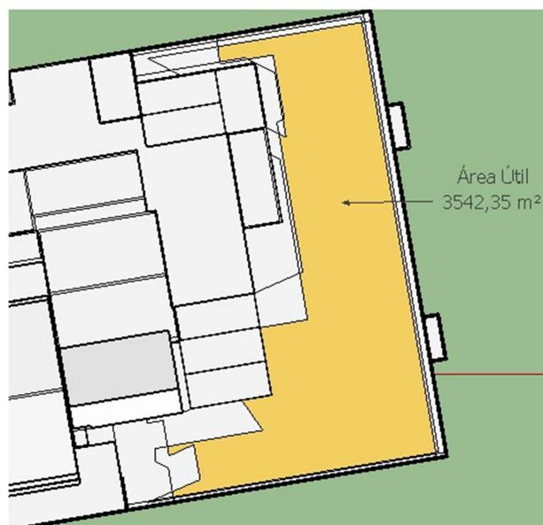
Figura 5 – Área útil para instalação dos painéis FV.
