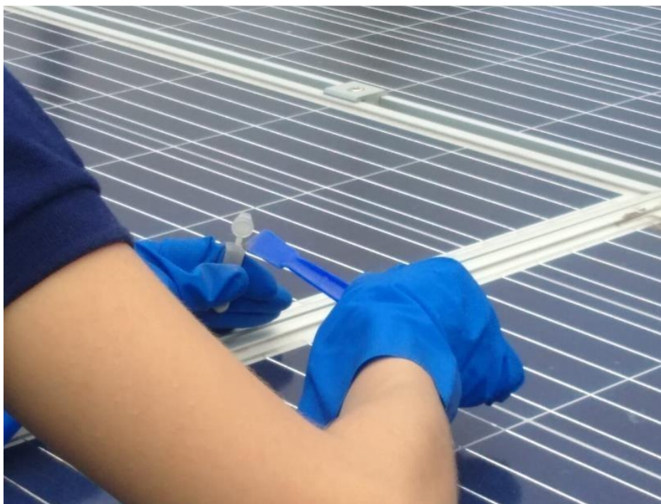
Figura 4 – Processo de coleta da sujidade.
