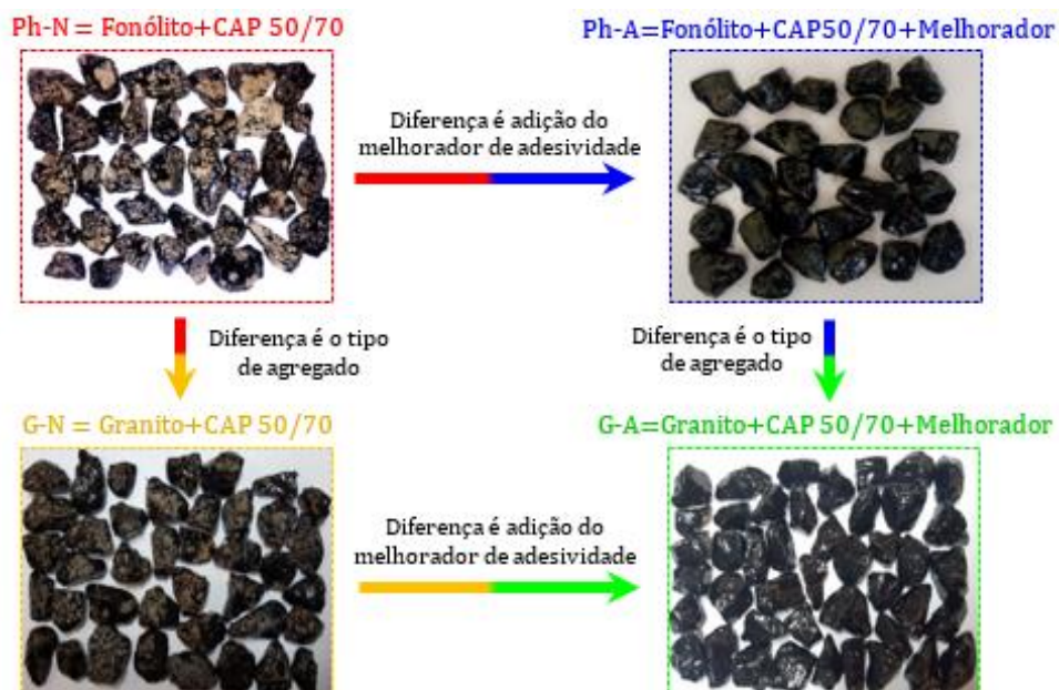
Figura 1 – Ensaio de adesividade das misturas asfálticas investigadas
