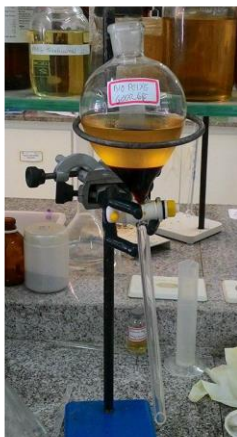
Figura 4 – Etapa de separação das fases biodiesel de óleo de peixe (superior) e glicerina (inferior)
