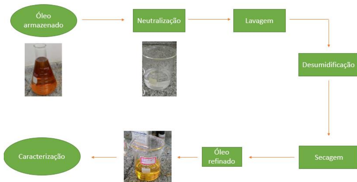
Figura 1 – Fluxograma geral do processo de pré-tratamento do óleo a partir das vísceras de Tilápia
