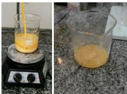
Figura 3 – Procedimento para separação do sabão: mistura em aquecimento (esquerda) e o sabão (direita).
