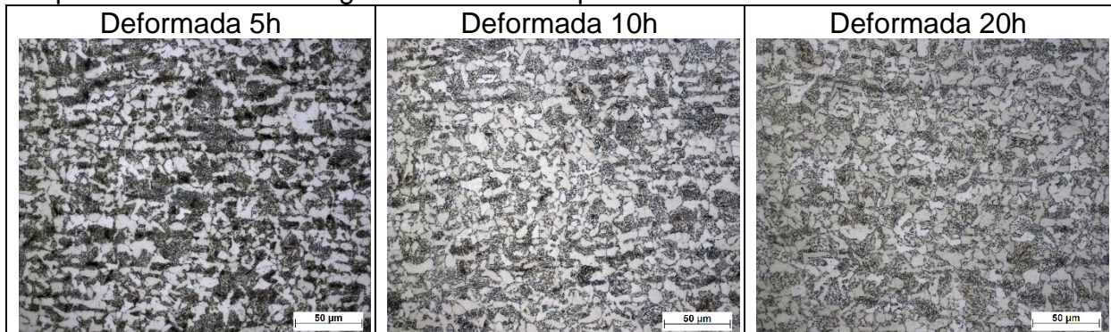
Figura 2 Microestrutura das amostras previamente normalizadas e deformadas, após o tratamento de esferoidização. Ataque NITAL 2%. Aumento 500X
