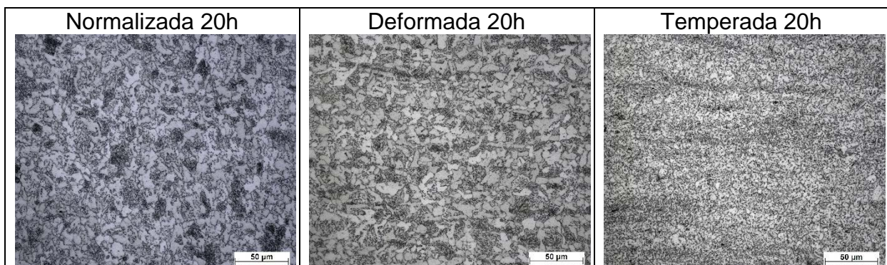
Figura 4 Microestrutura das amostras previamente, ao final o tratamento de esferoidização. Ataque NITAL 2%. Aumento 500X
